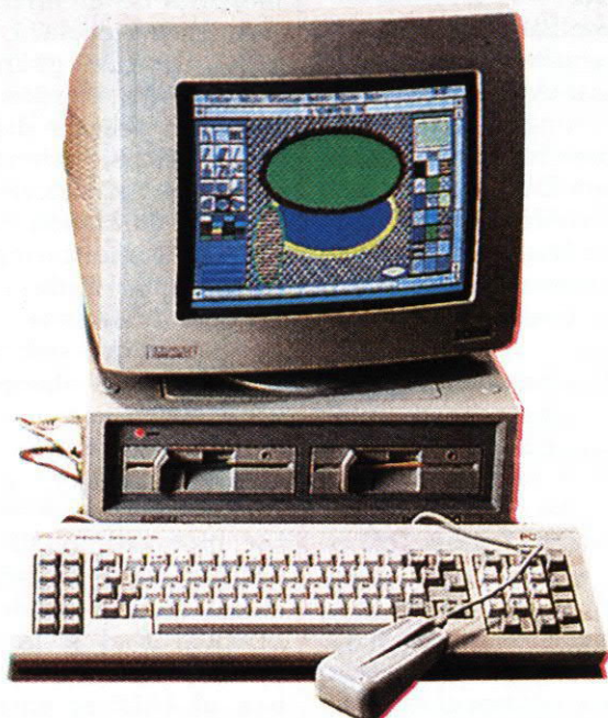
El PC1512 se entrega con una sola toma de corriente, un solo interruptor y un solo ratón, así como con los programas Gem Desktop y Gem Paint.
